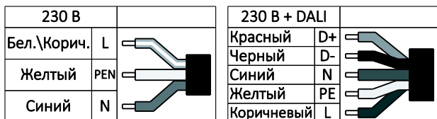
Рисунок 2. Схема подключения питания.
