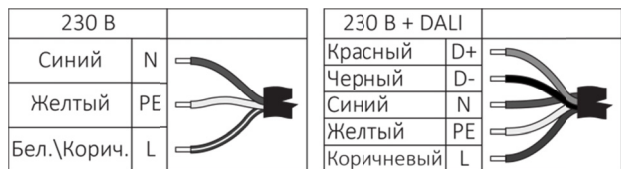
Рисунок 2. Схема подключения питания.
