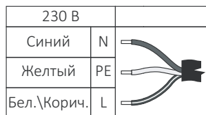
Рисунок 2. Схема подключения питания.
